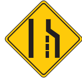
Fin d'une voie Fin le la voie de droite
