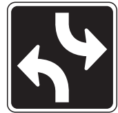
Voie pour virage à gauche dans les deux sens
