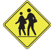
Signal avancé d'un passage pour écoliers
