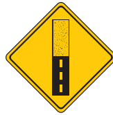
Fin du revêtement Début d'une chaussée en gravier
