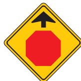
Signal avancé d'arrêt
