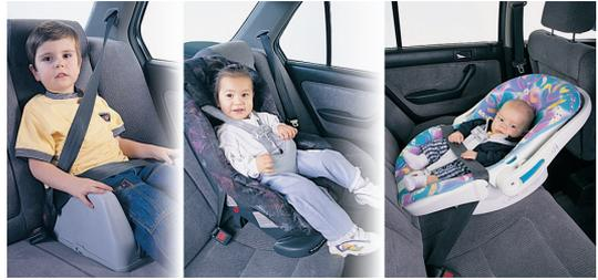
part des fabricants de véhicules et de sièges pour enfants recommandent de ne pas installer un système de retenue pour enfants sur le siège avant du côté passager, préconisant plutôt de l'installer sur la banquette arrière.
