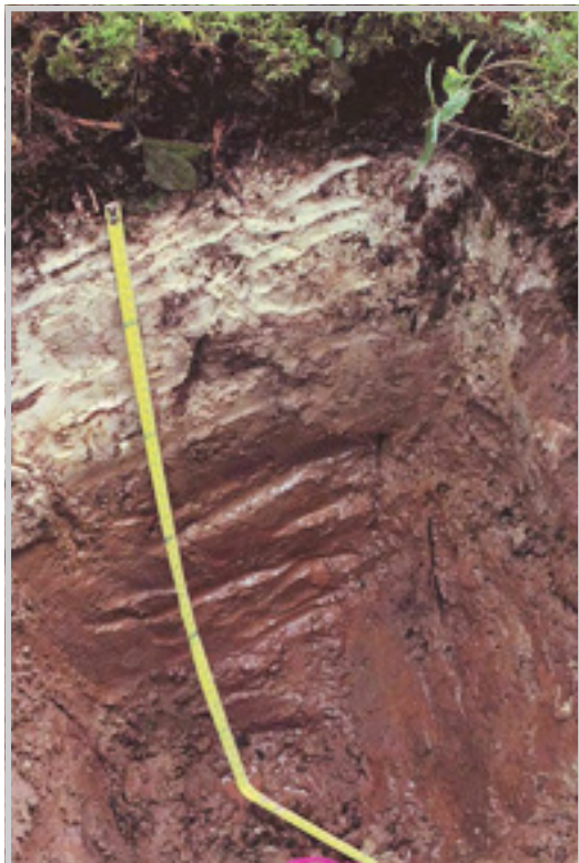
L'écodistrict repose sur des sols en profondeur qui sont des argiles loameux peu perméables, comme celle qui figure ici. La productivité forestière est généralement pauvre, sauf où les pentes douces contribuent à l'amélioration du drainage.
