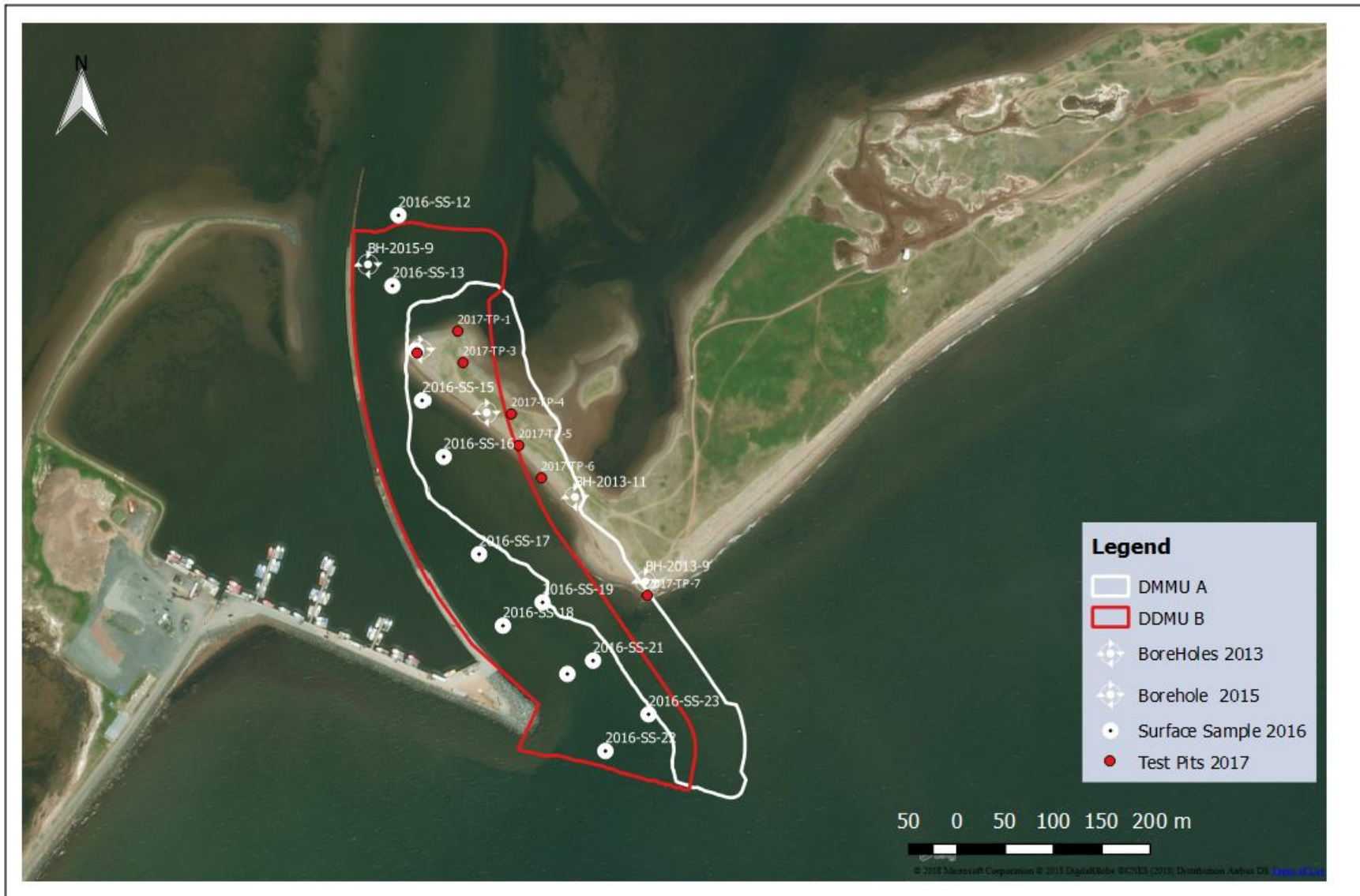
Figure 1. Emplacements des UGMD et des trous de sondage, de l'échantillonnage de surface et des puits de reconnaissance.
