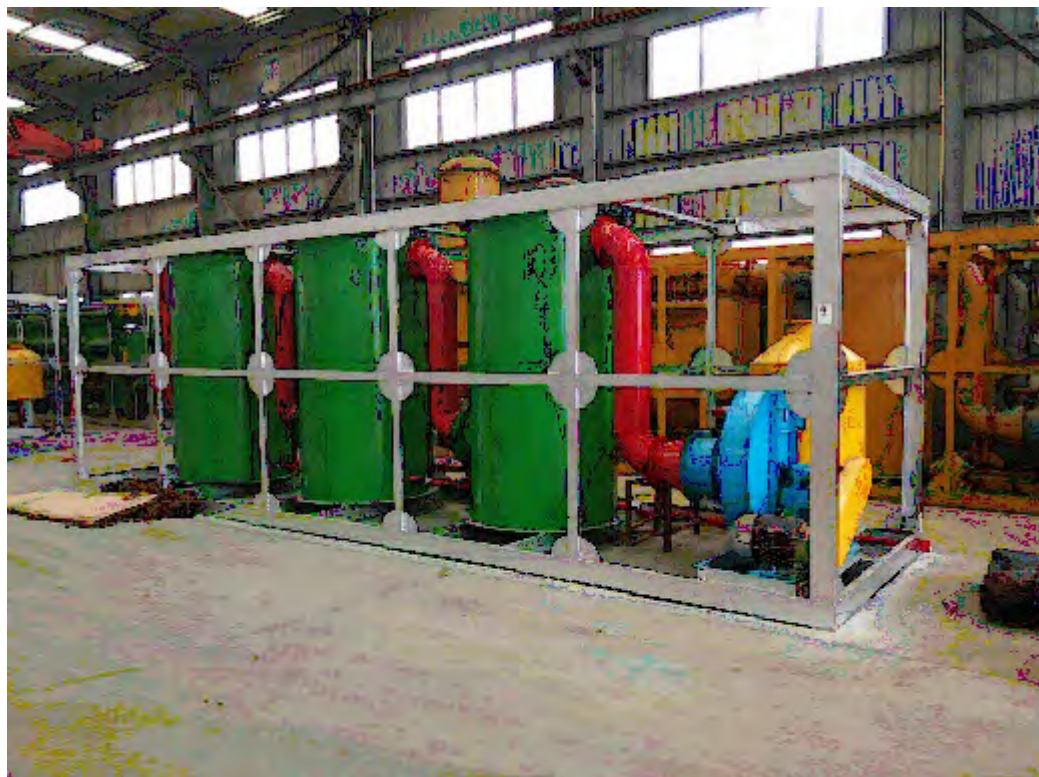
Figure 3.4: Le systeme d'épuration des effluent
