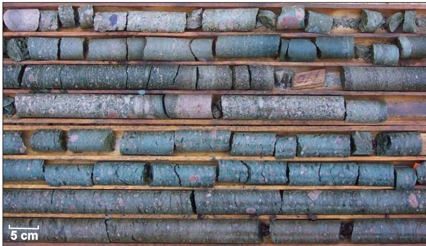
Figure 3. Teneurs aberrantes en uranium (et en thorium) observées dans des roches volcanoclastiques altérées du complexe volcanique de Mount Pleasant.
