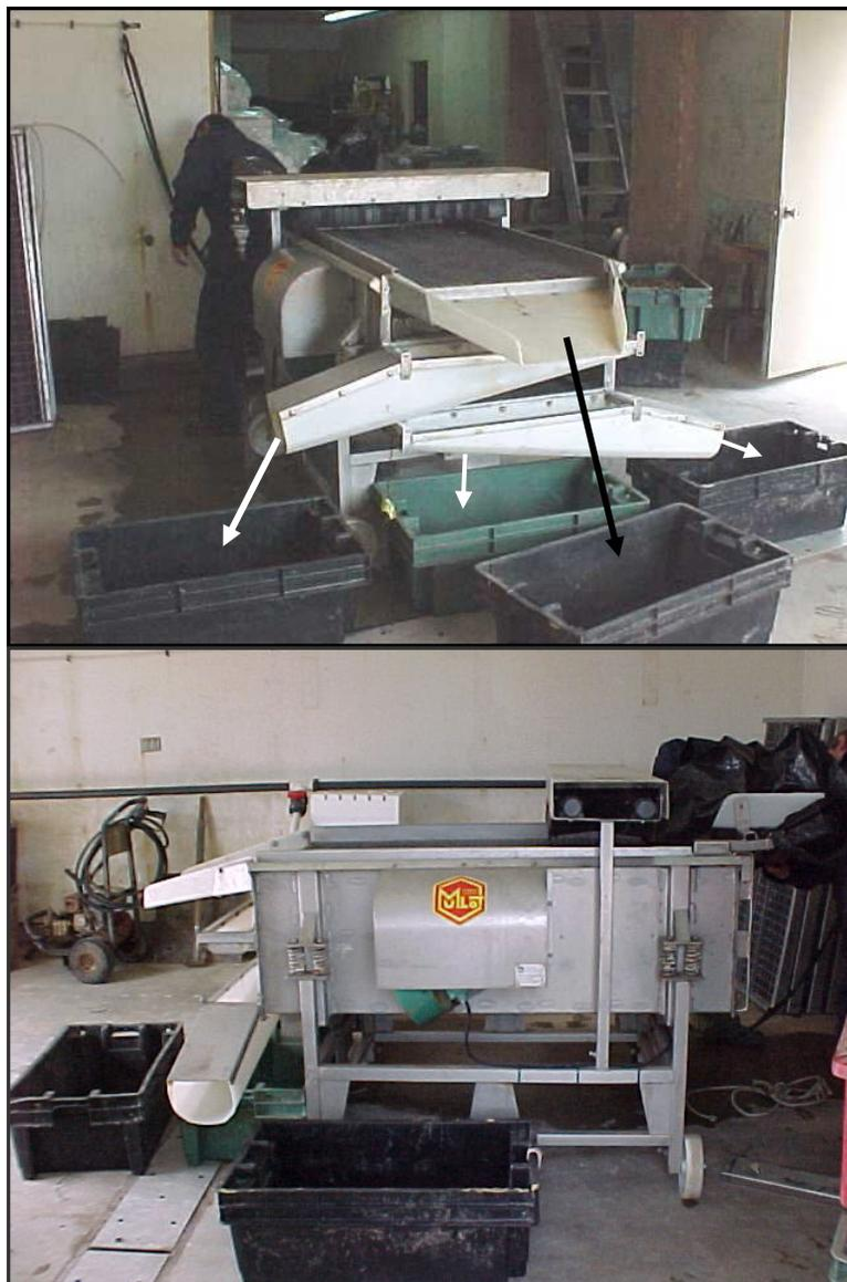
**Figure 29 : Crible vibrant (Fabrication industrielle)**
