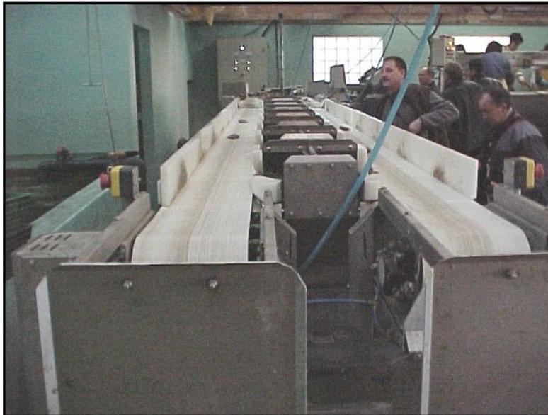
**Figure 43 : Extrémité d'une calibreuse d'huîtres**
