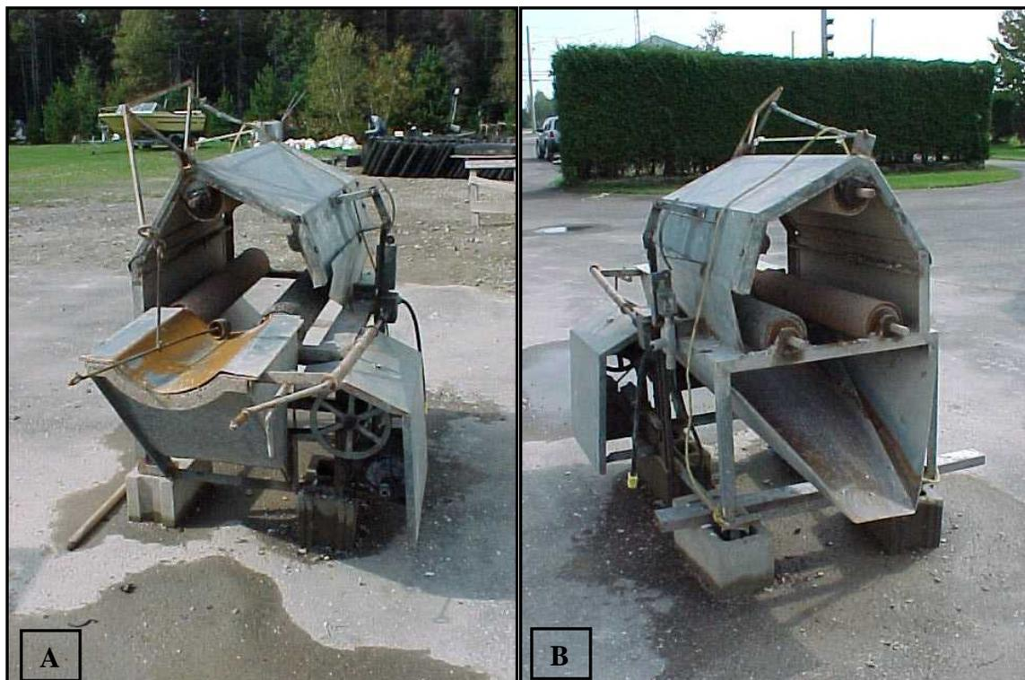
**Figure 20 : Détroqueuse (A - Entrée du collecteur B - Sortie des huîtres)**
