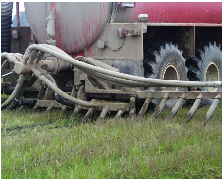
Photo C - Tubes d'application en surface
